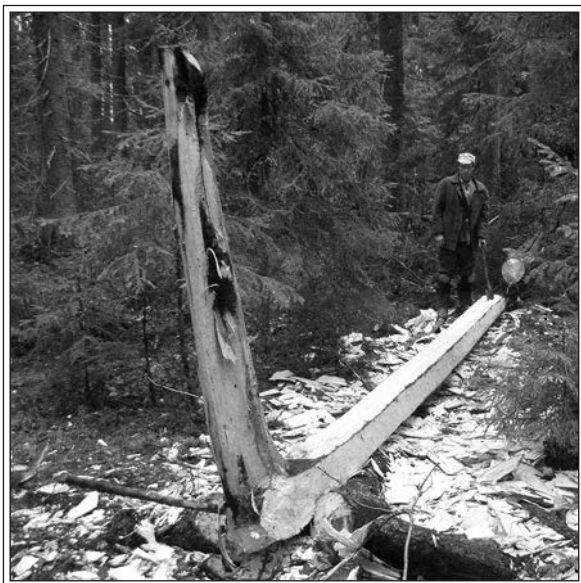
Заготовка кокоры на курицу для постройки реплики коча Октябрь 2012 г.
